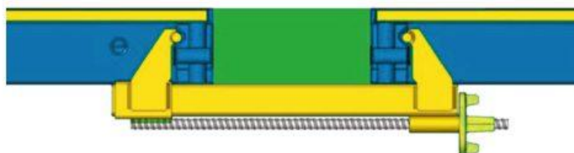
Рис.7 Соединение линейных щитов через вставку 250 мм
